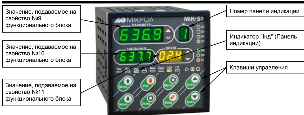
Рисунок 4.6 - Лицевая панель в режиме оперативного управления пользовательскими панелями
