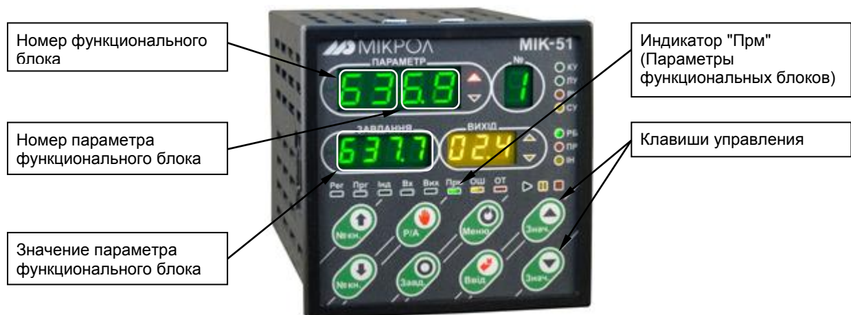
Рисунок 4.9 - Лицевая панель в режиме индикации параметров функциональных блоков
