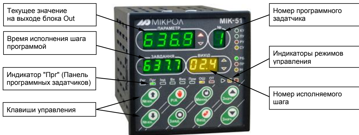
Рисунок 4.5 - Лицевая панель в режиме оперативного управления программным задатчиком
