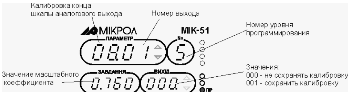
Рисунок 9.4.2.2 - Внешний вид индикаторов при калибровке конечного значения аналогового выхода
