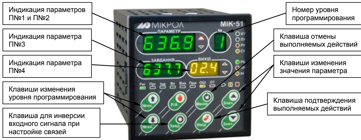
Рисунок 5.1 - Лицевая панель контроллера МИК-51 в режиме программирования
