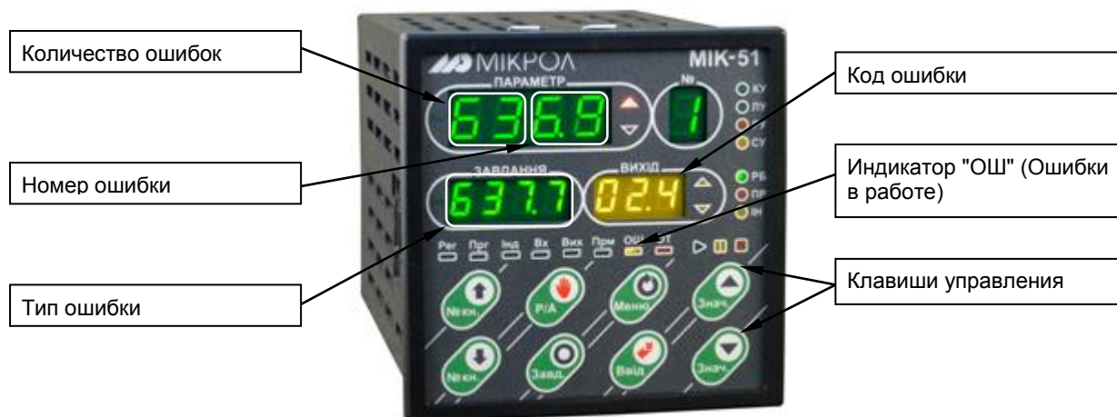
Рисунок 4.9 - Лицевая панель в режиме индикации ошибок
