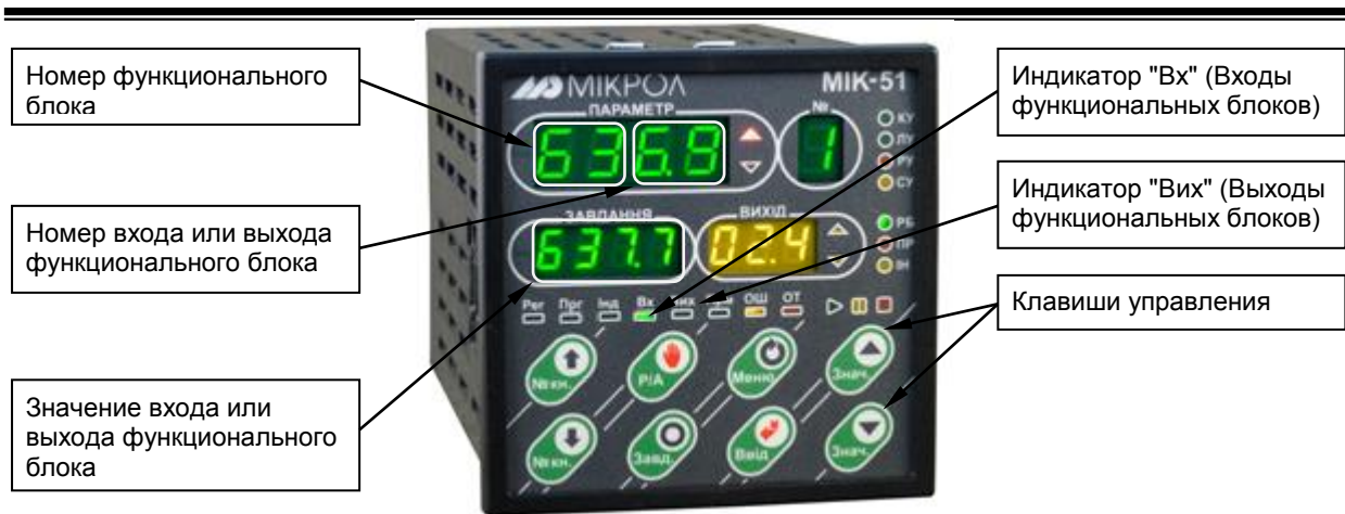
Рисунок 4.7 - Лицевая панель в режиме индикации входных или выходных параметров функциональных блоков
