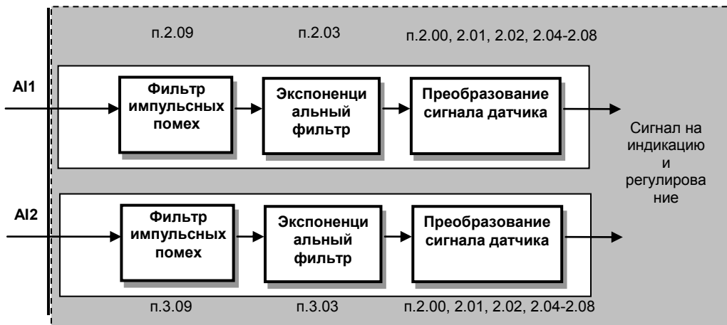
Рисунок В.5 – Функциональная схема программного преобразования входных аналоговых сигналов
