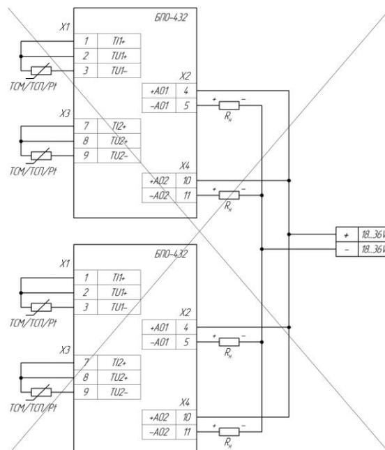
Рисунок 3.5 – Запрещенная схема электрических подключений блока БПО-430/БПО-432
