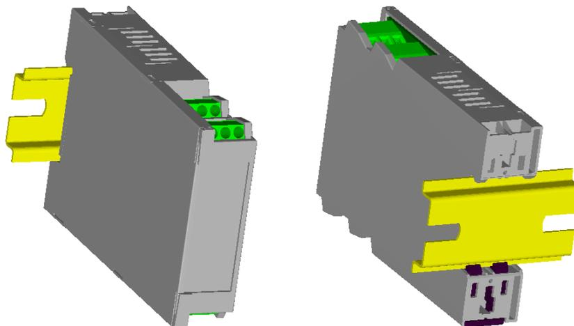
Рисунок 3.2 – Схема крепления блока БПО-430/БПО-432 на DIN-рейку
