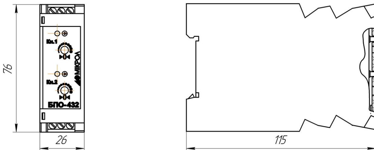
Рисунок 1.2 – Внешний вид и габаритные размеры БПО-432
