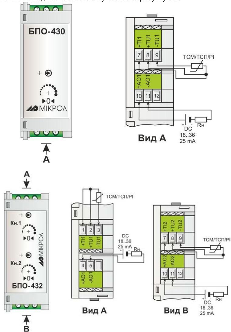
Рисунок 3.4 – Схема электрических подключений блока БПО-430/БПО-432
