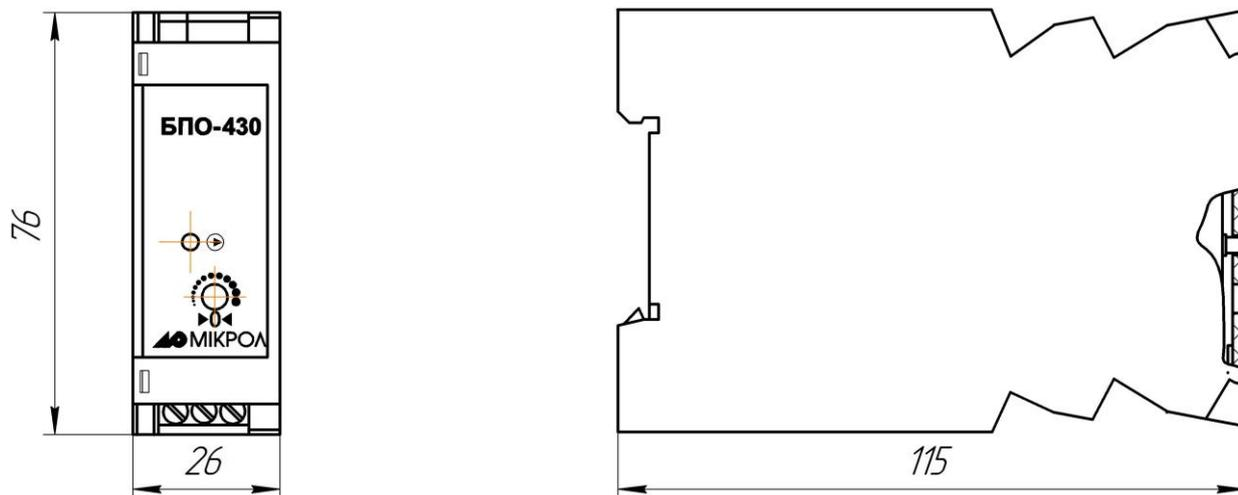
Рисунок 1.1 – Внешний вид и габаритные размеры БПО-430
