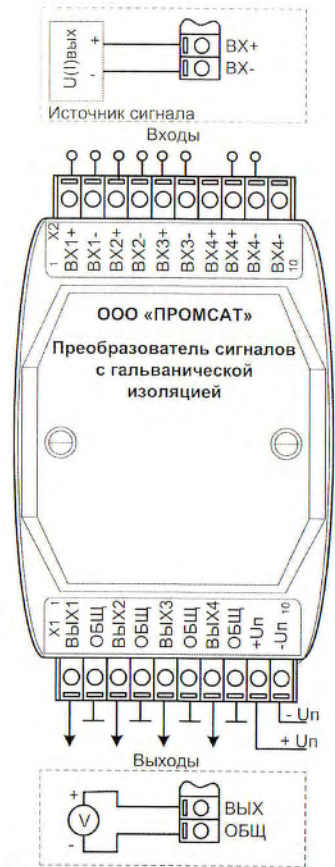
Рис 5.2 Схема подключения преобразователя
