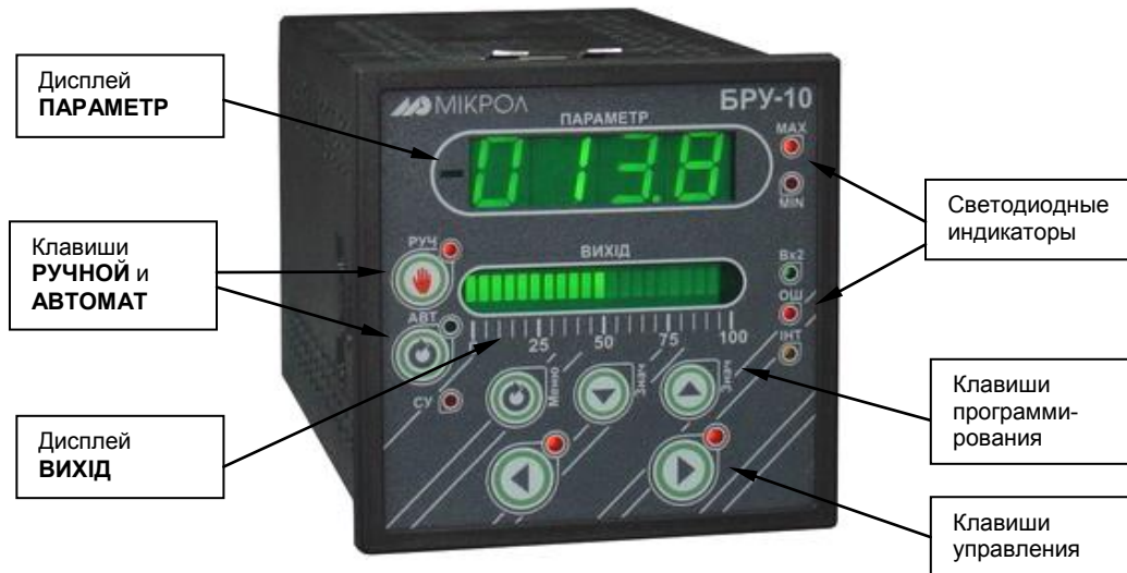
Рисунок. 5.1 - Внешний вид передней панели блока ручного управления БРУ-10
