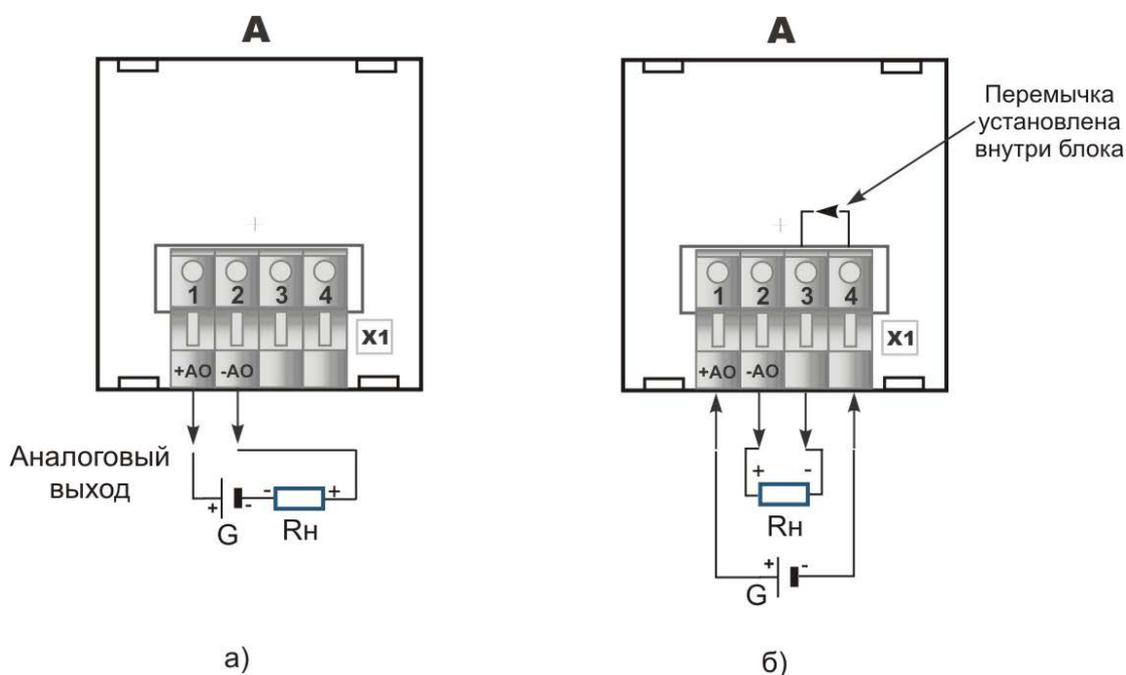
A - блок ручного управления БРУ-420 (вид с тыльной стороны блока)
