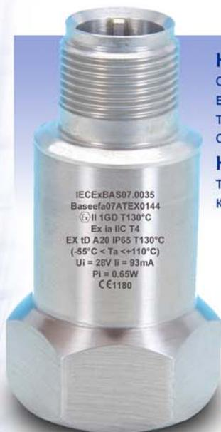
**HS-100I и HS-100SI серии** промышленных акселерометров представляют собой АС версии сертифицированные АТЕХ и IEC Ex для потенциально взрывоопасных средах (Группа I и Группа II). Они обычно работают в температурном и частотном диапазонах  $-55 - 140$  С и 2 Гц – 10 кГц, соответственно.
