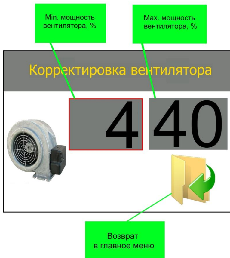
Рисунок 12 – Окно корректировки вентилятора
