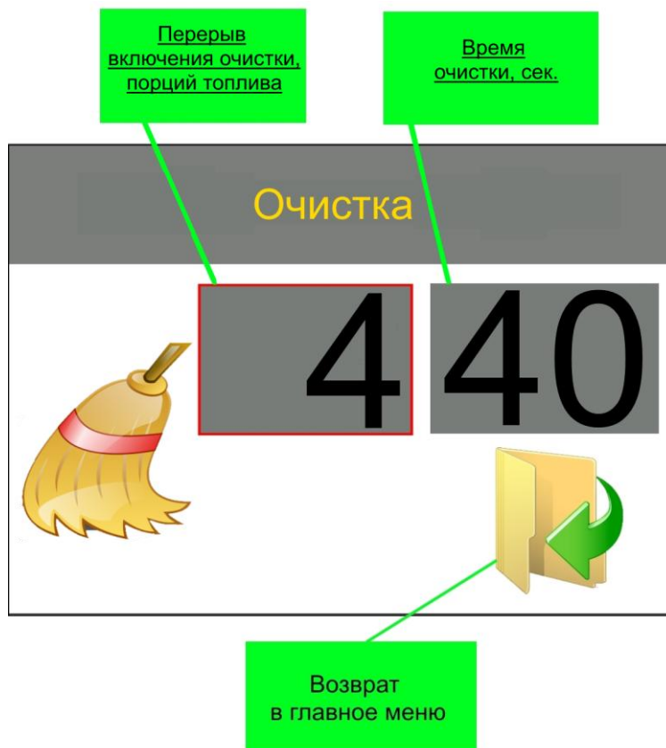
Рисунок 13 – Окно настройки параметров очистки горелки
