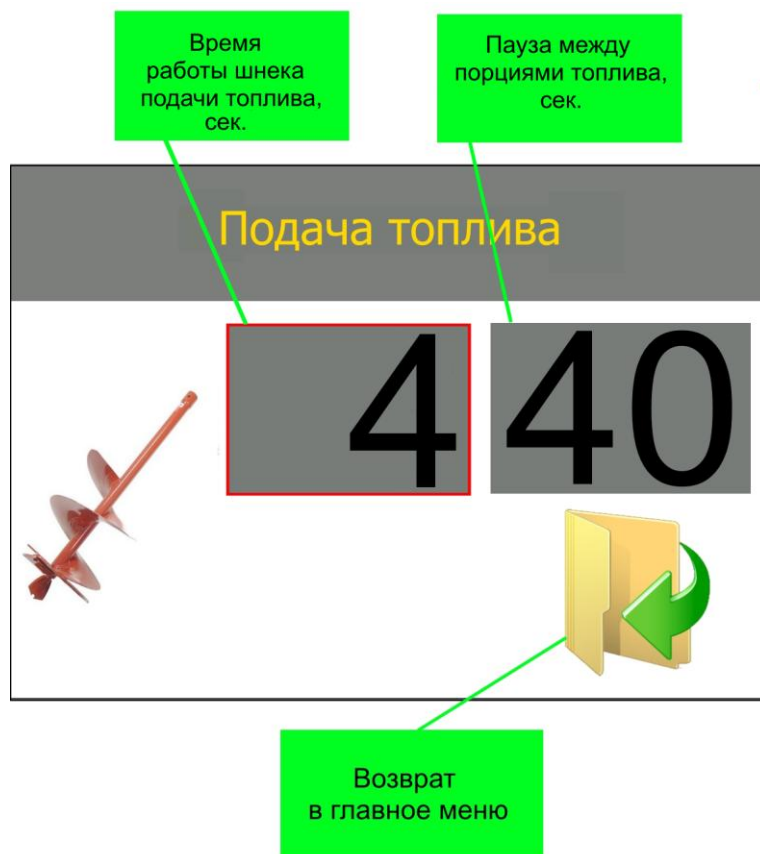
Рисунок 11 – Окно настройки параметров подачи топлива
