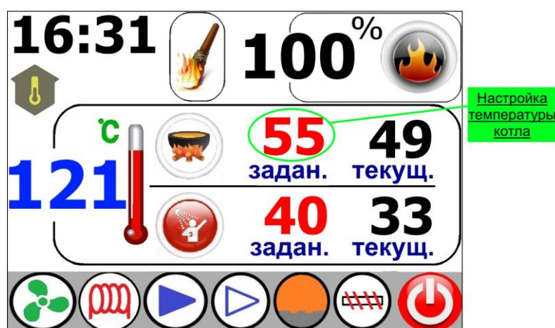
Рисунок 5 – Изменение температуры котла
