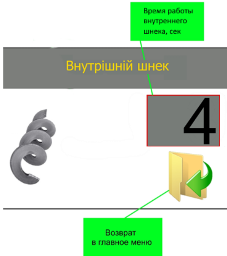
Рисунок 10 – Окно настройки работы внутреннего шнека
