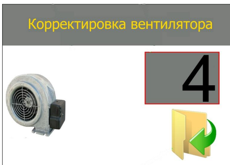
Рисунок 17 – Окно изменения мощности вентилятора (розжиг)
