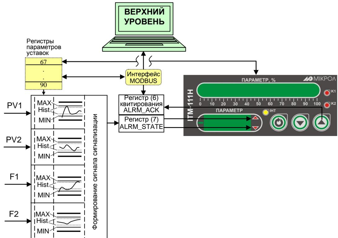
Рисунок 3.5 – Блок-схема работы сигнализации
