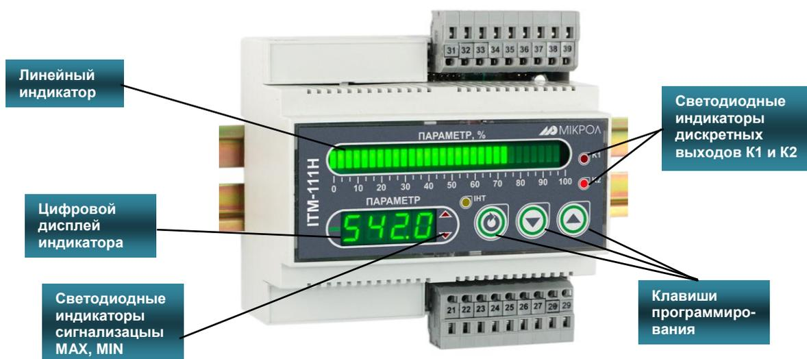
Рисунок 3.1 - Внешний вид передней панели индикатора ИТМ-111Н.
