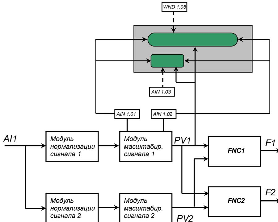
Рисунок 3.7 – Блок-схема работы окна индикации при выборе варианта индикации «Одноканальный индикатор».
