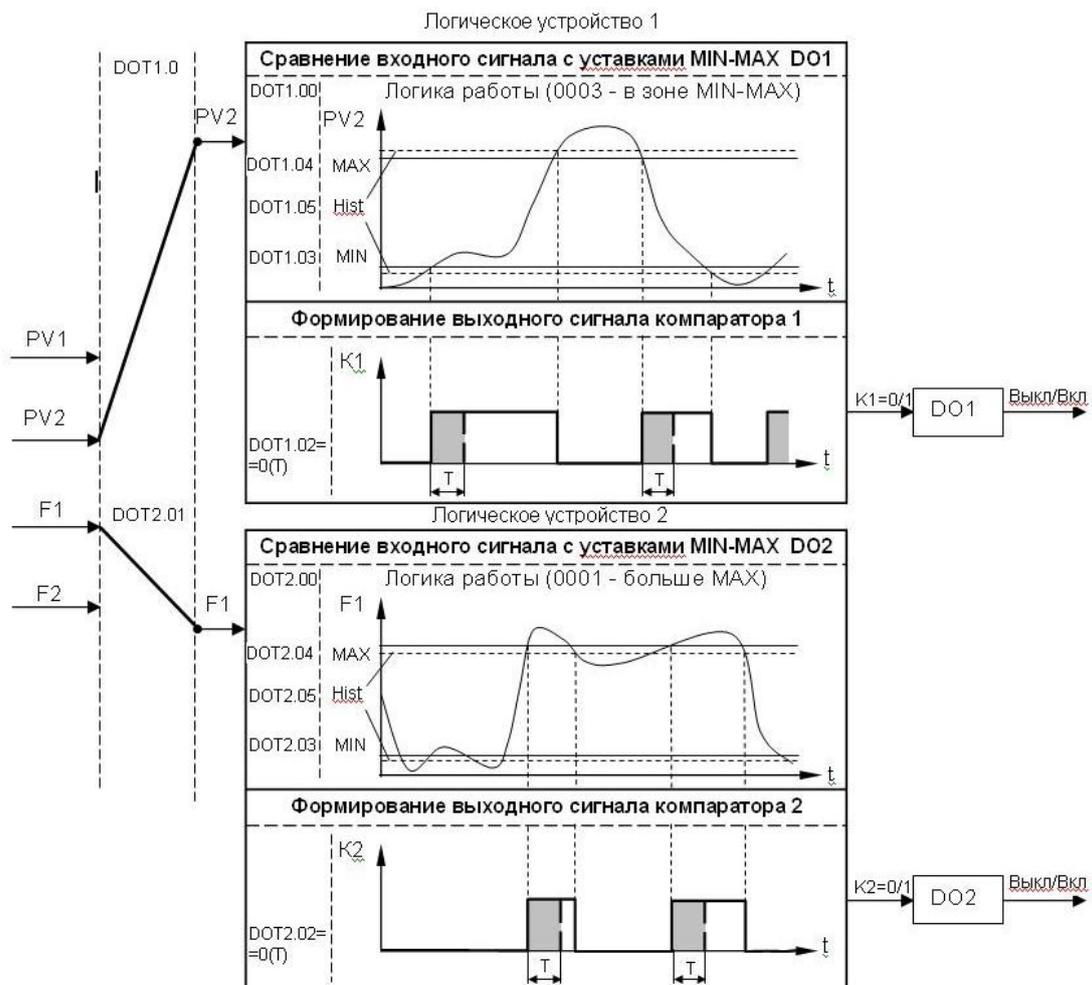
Рисунок 3.8 – Функциональная схема принципа работы компаратора
