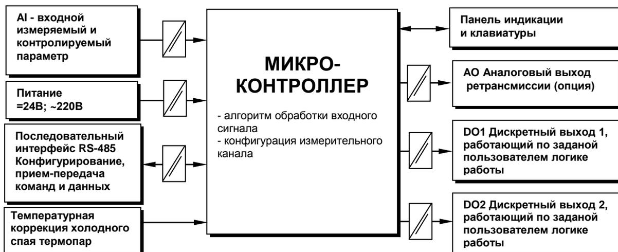
Рисунок 3.2 - Структурная схема индикатора ИТМ-111Н
