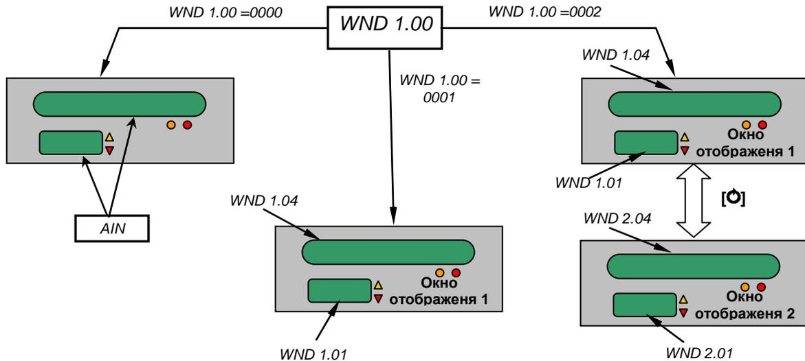
Рисунок 3.6 – Блок-схема выбора вариантов отображения измерительного параметра
