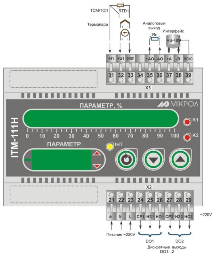
Рисунок Б.1 Подключение внешних цепей к индикатору ИТМ-111Н
