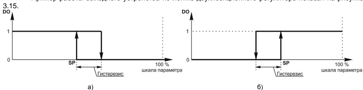
Рисунок 3.15 – Пример работы выходного устройства: а) по логике обратного 2-х позиционного управления п. CTRL.00=0000, п. CTRL.01=0000, б) по логике прямого 2-х позиционного управления п. CTRL.00=0000, п. CTRL.01=0001
